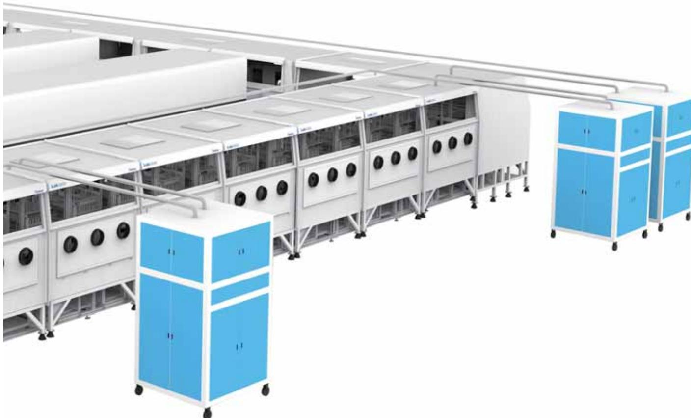
一体化锂电生产线由真空隧道干燥炉，预处理手套箱，注液手套箱，上料系统，全自动注液机，称重系统，电池盖帽焊接系统，下拉式封口系统，下料系统组成，整个电池的生产从干燥开始一直到封好口的电池全部在超低水氧含量的手套箱中完成。
